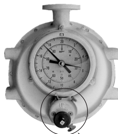
フロート巻上げ機構部
