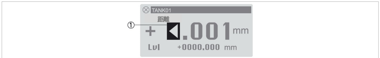
図 5-2: エラーシンボル: 測定値の桁数、小数点位置が正しくない
