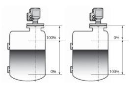
測定レンジ プロセス接続部から最低レベルまでの距離 DL: ( )m プロセス接続部から最高レベルまでの距離 DH: ( )m
