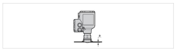
DN20, DN25, DN40 レンズアンテナをねじ込み接続で設置の場合 a 寸法は 6mm となります。
