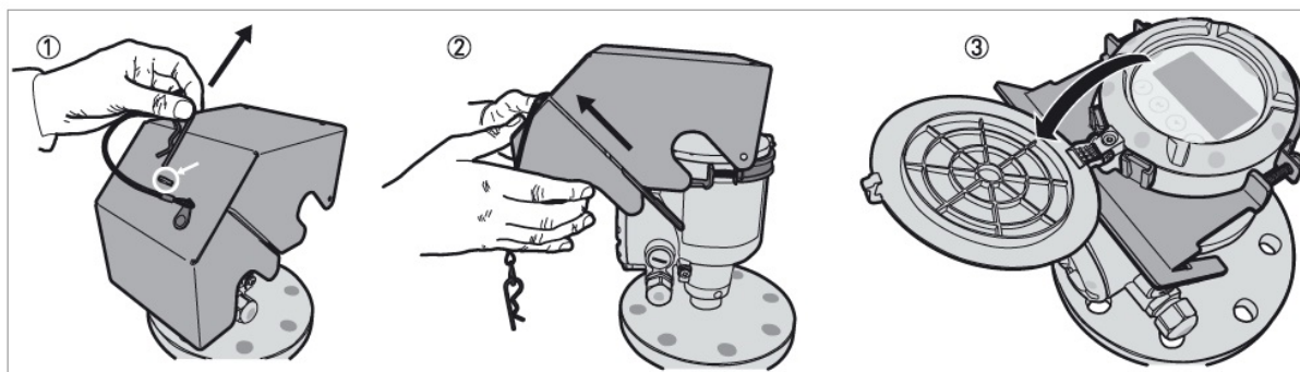
図 2-26：日除けカバー、表示カバーの開け方
