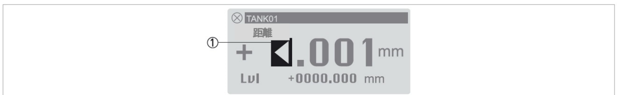
図 5-2: エラーシンボル : 測定値の桁数、少数点位置が正しくない
