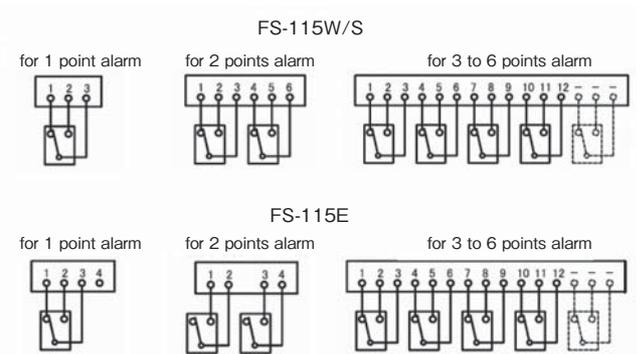
Fig. 11 : Terminal arrangement
