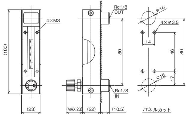
(注意) 固定ねじが長い場合、テーパ管を破損する恐れがあります。ねじ長さ: パネル厚+3 mm 以下として下さい。
