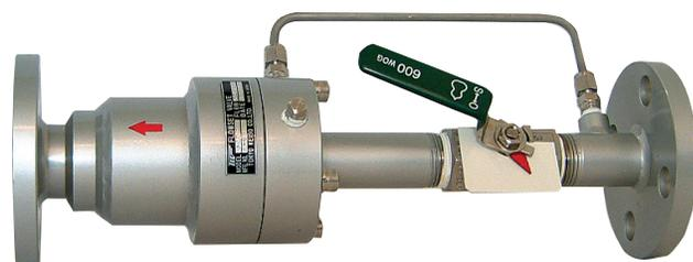
流入量圧力 P1 が増加するか流出側圧力 P3 が減少すると、差圧 (P2 - P3) は大きくなります。ダイアフラム前後の差圧 (P1 - P2) も同様に大きくなりダイアフラムに連結されているバルブを押し流量を減少させることとなります。圧力 P1、P3 の変化が反対の場合も同様に流量は自動的にもとの設定値になるようにダイアフラムは動作します。バランスしてるときには次式が成り立ちます。
