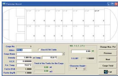
ご希望の種類の積載カーゴデータを登録し、カーゴタンクのグラフィックス上でカーゴ量を質量 (M/T) で入力できます。
