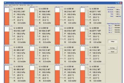
受信したタンクレベルよりカーゴの質量、体積を計算し、グラフィック上に表示します。
