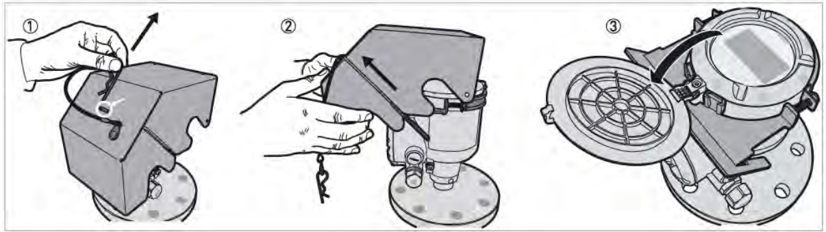
図 2-26：日除けカバー、表示カバーの開け方
