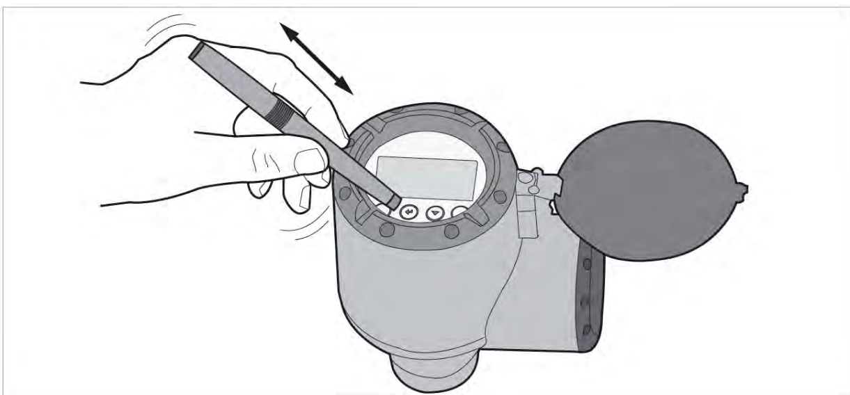
図 4-4: データ設定用マグネットを使用したキーボタンの操作方法
