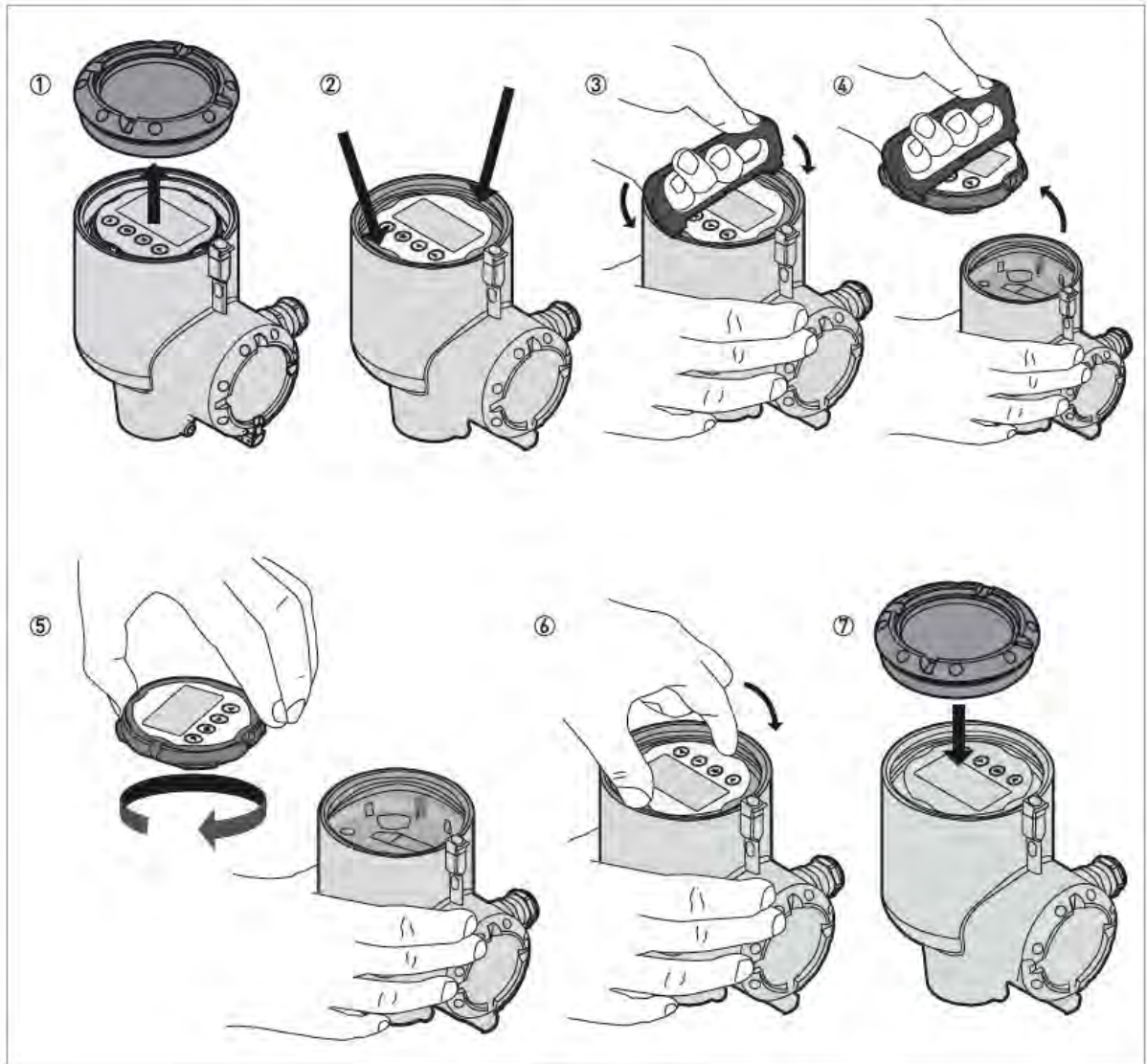
図 2-23: 表示部の取外し、回転方法
