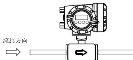
流れ方向マークとプロセスの流れ方向を一致させて取り付けた場合に表示部が見にくい方向を向いてしまうときは、次の方法により流れ方向設定を変更してください。
