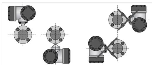
測定管内が常に流体で満たされるような配管位置に取り付けてください。測定管内が満液でないと、正しい測定はできません。
