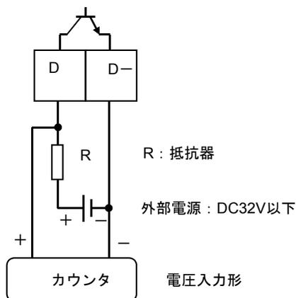
※ 外付け抵抗器の値はカウンタの入力電圧範囲を考慮し、かつパルス出力端子の入力電流が100mA以下（ $\leq 10\text{Hz}$ ）、20mA以下（ $\leq 10\text{kHz}$ ）となるように決定してください。
