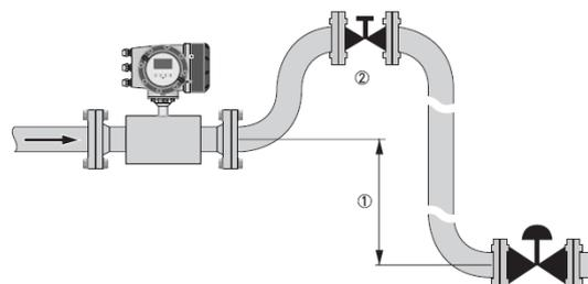
流量調節バルブは、必ず流量計の下流側に設置してください。上流側のバルブはキャビテーションおよび流速分布の乱れにより、測定に影響を及ぼします。
