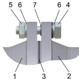
配管側フランジ間にアース線 ( $\geq 4 \text{ mm}^2$ ) を接続してください。ただし、流量計のアース端子にはアース線を接続しないでください。
