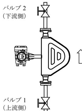
下図はバイパス管を設置した例です。流量計メンテ
