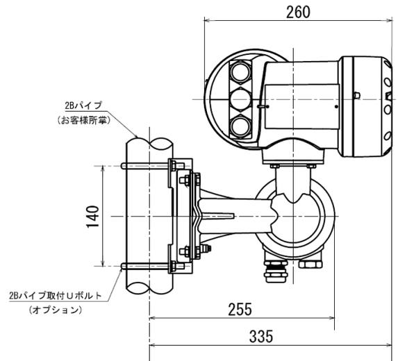
分離形変換器は壁取付けまたは2Bパイプ等に取付けが可能です。
