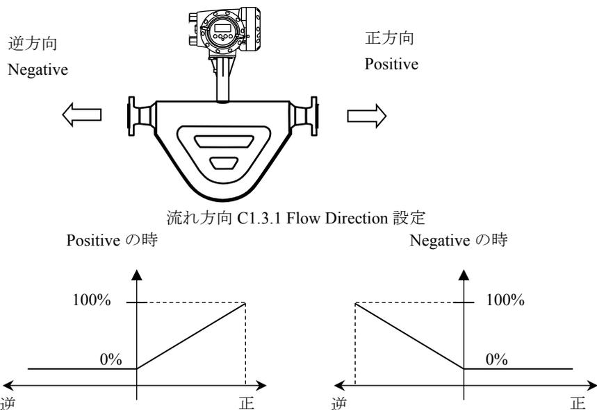
電流出力（Current out A）を以下のように正逆両方向出力にする場合の設定例を下記に示します。
