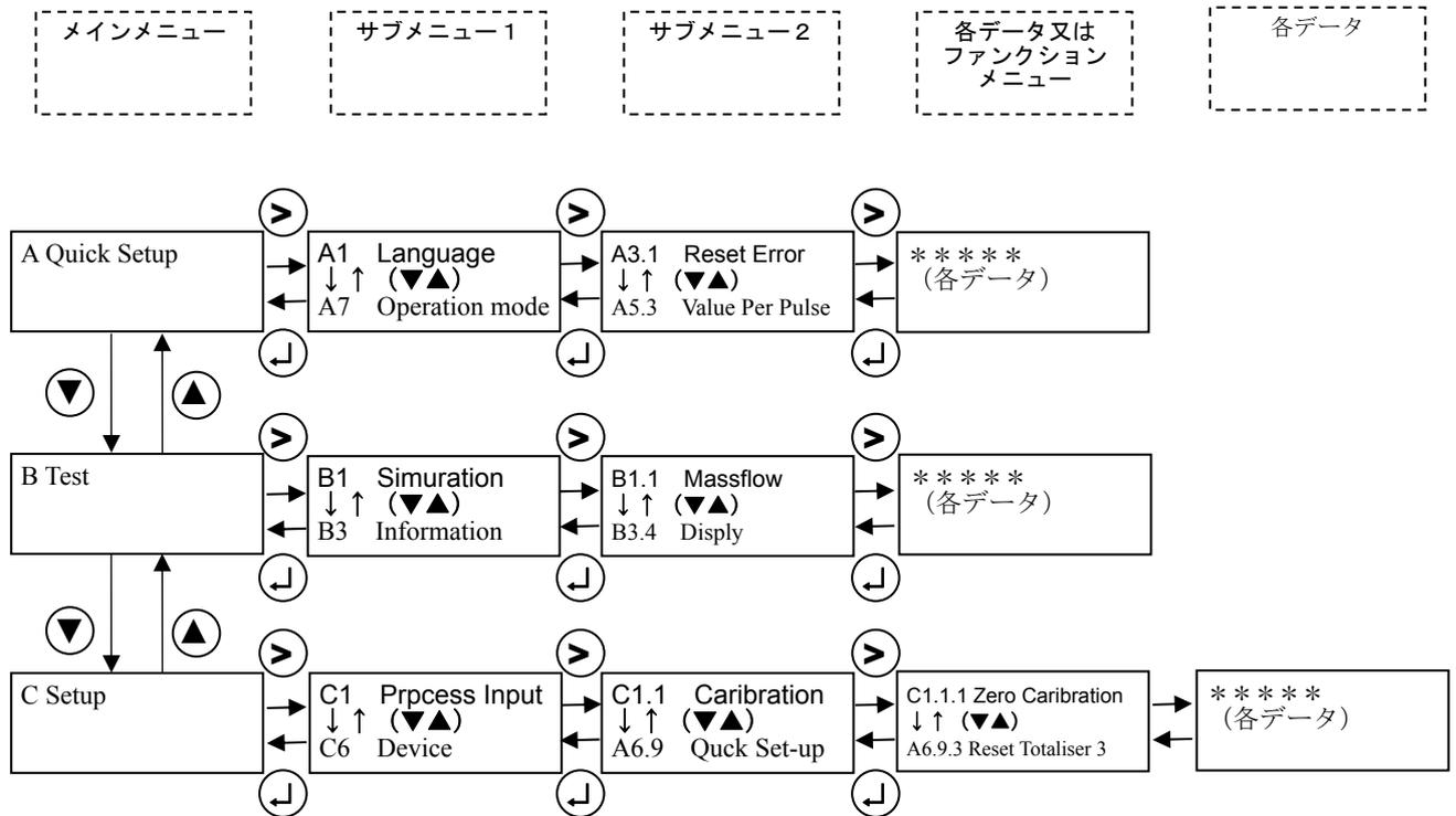
設定モードは➤, ⏪, ▲, ▼の赤外線センサをタッチすることによって操作します。
