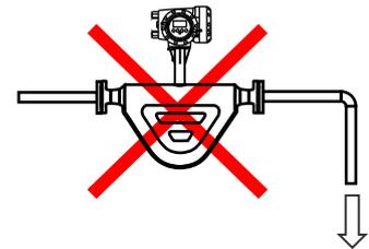
開放配管に取付ける場合には、配管の低い部分に設置してください。
