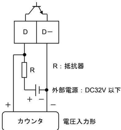
※ 外付け抵抗器の値はカウンタの入力電圧範囲を考慮し、かつパルス出力端子の入力電流が 100mA 以下 (≦10Hz)、20mA 以下 (≦10kHz) となるように決定してください。
