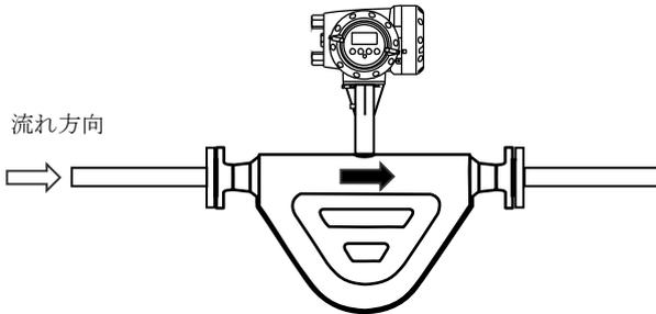
流れ方向マークとプロセスの流れ方向を一致させて取り付けた場合に表示部が見にくい方向を向いてしまうときは、次の方法により流れ方向設定を変更してください。
