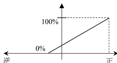
パルス出力（Pulse Output D）を正逆両方向出力にする場合の設定を以下に示します。
