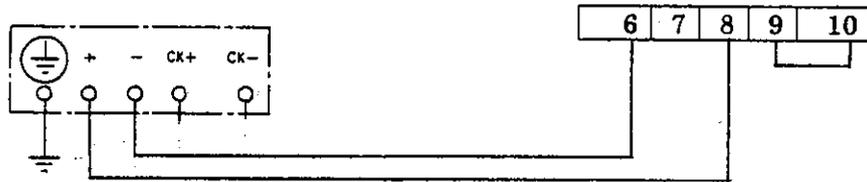
アナログ (DC 4~20mA 出力) 流量計 (流量計への電源は別途供給されるもの)
