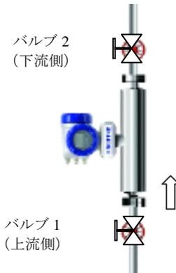
下図はバイパス管を設置した例です。流量計メンテナンスや交換時等設備の運転を停止されことなく流量計の取り外しができ便利です。
