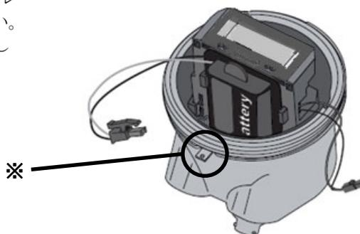
バッテリーの交換が終了したら、バッテリーの残量カウンターのリセットを次の手順でおこないます。
